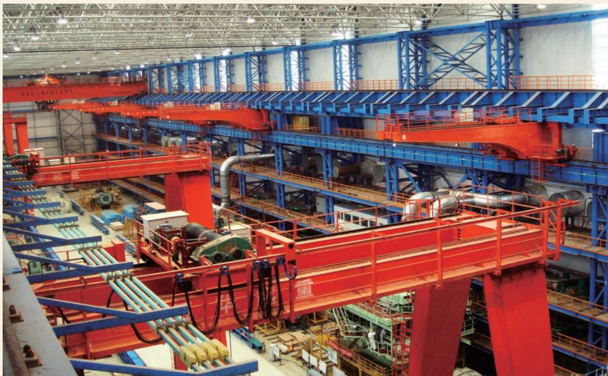
我国起重量最大、悬臂最长的壁行式悬臂起重机
