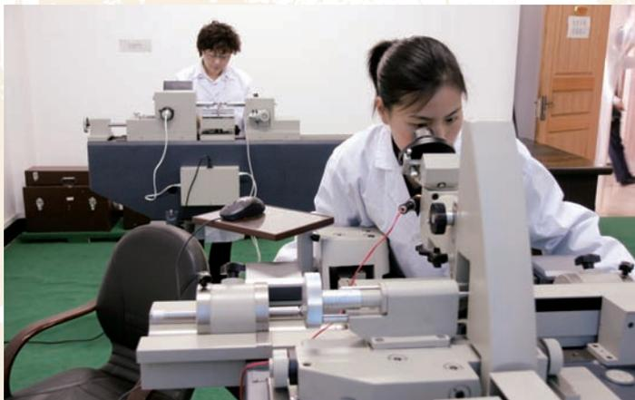
万能工具显微镜及投影一米测长机
