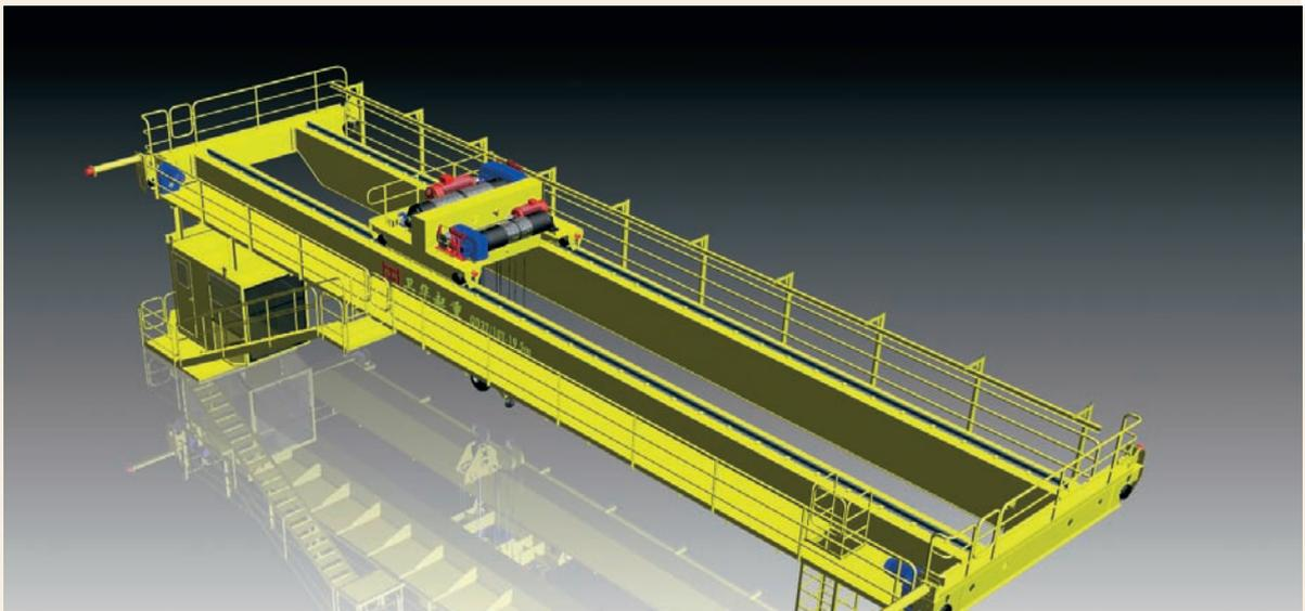
欧式起重机具有尺寸小，重量轻，轮压小的特点。与传统起重机相比，吊钩至墙面的极限距离最小，净空高度最低，起升高度更高，实际增加了现有厂房的有效工作空间。由于起重机的自重轻、轮压小，新厂房空间可以设计的更小，功能更齐全，节省厂房投资。
