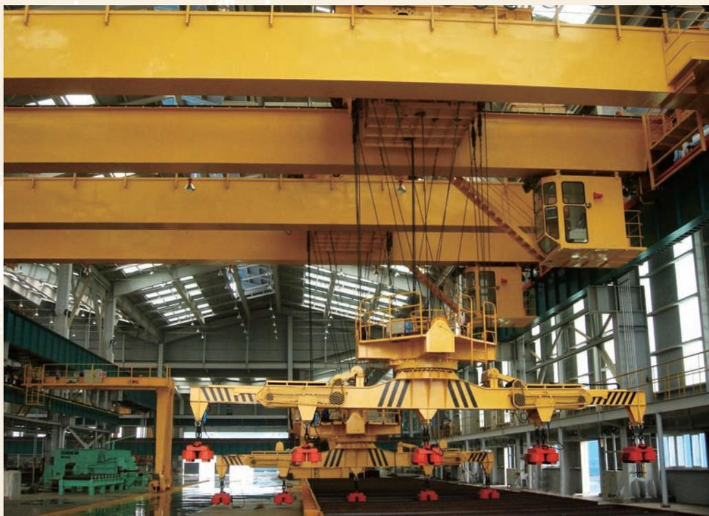
可伸缩且可360度旋转电磁挂梁系统起重机
