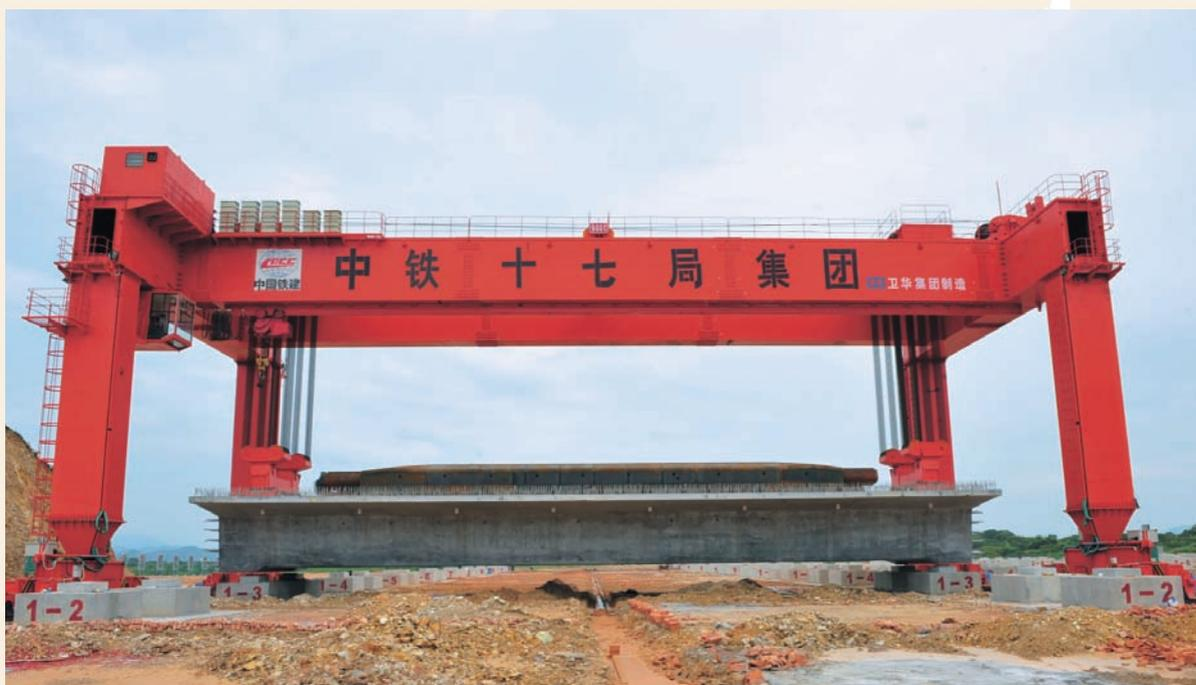
为中铁十七局设计制造的900t移梁机
