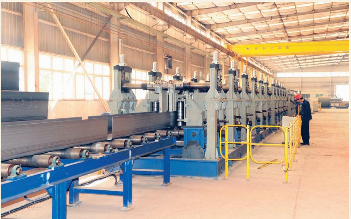
U型槽冷轧成形生产线
