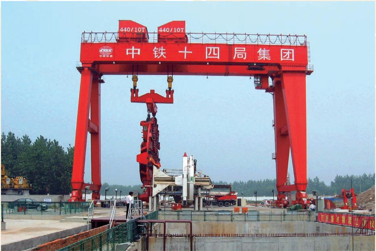
为中铁十四局生产的440t盾构用门式起重机
