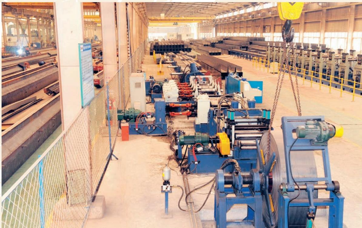
侧盖板冷弯成形生产线
