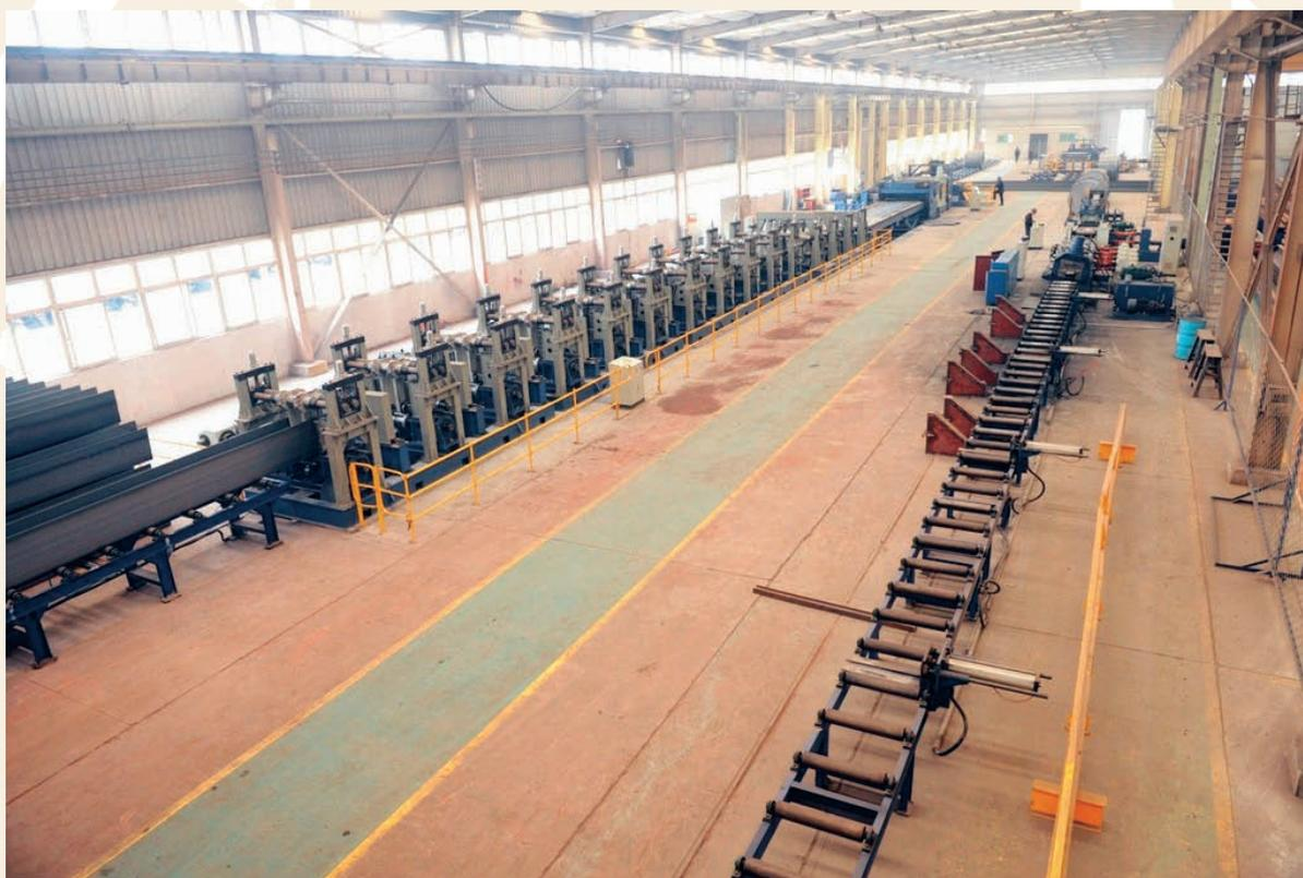
主梁无缝自动成型生产线
