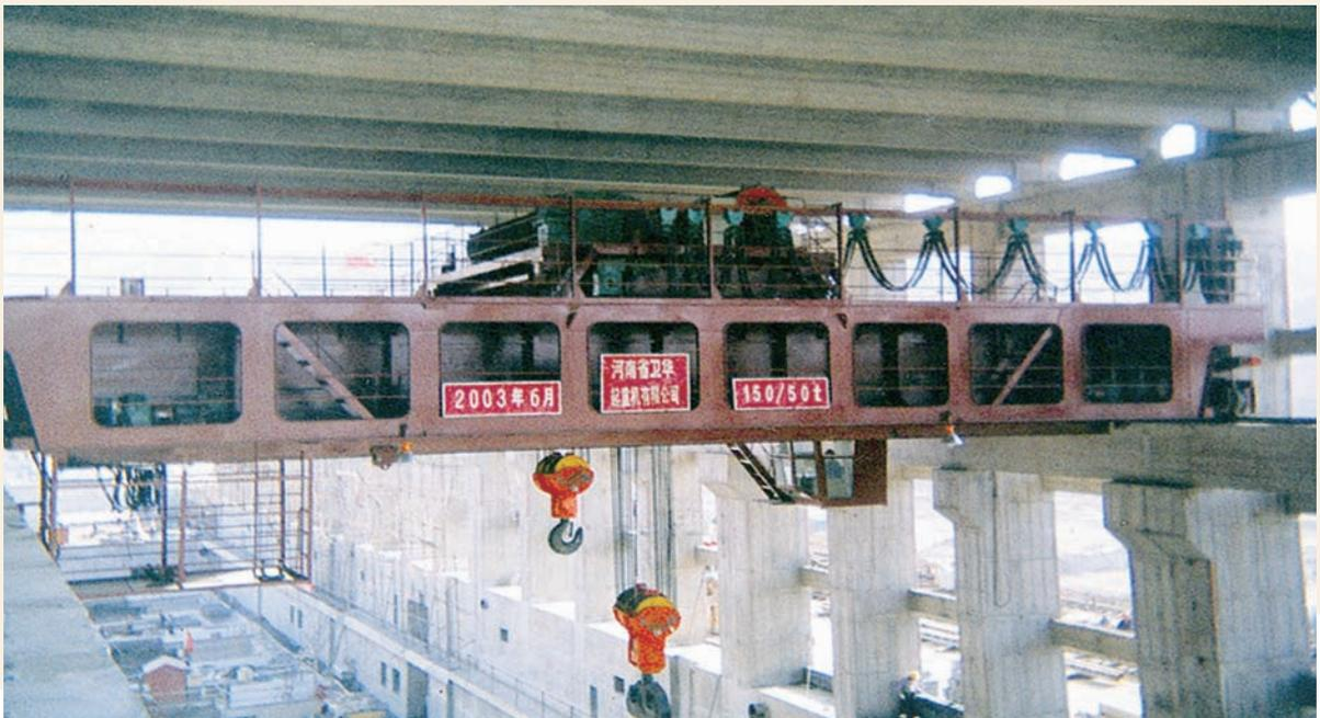
为宁夏沙坡头水利枢纽工程设计制造的QD 150/50t起重机
