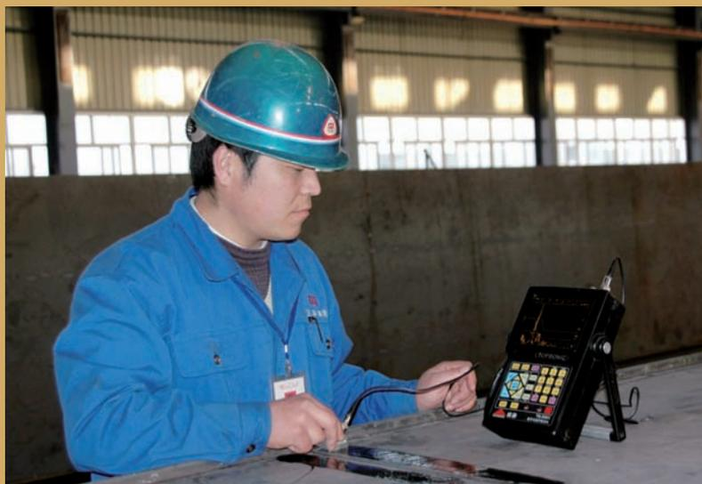
对焊接质量进行超声波探伤检测
